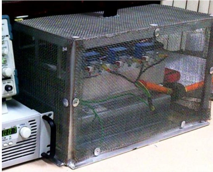
Figura 4.6 Jaula de Faraday en el inversor.
