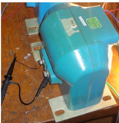
Figura 5.10 Transformador de potencial.
