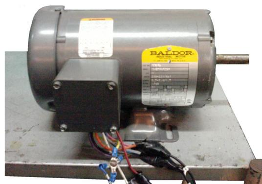
Figura 5.9 Motor de inducción trifásico Baldor industrial.
