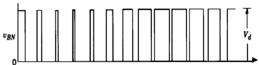
Figura 3-23(c) Señal PWM Obtenida de la Pierna B del Inversor al Negativo N
